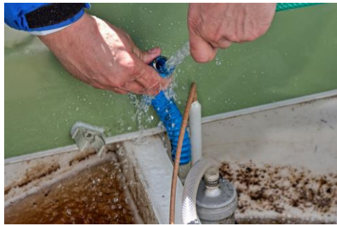
Rinçage des tuyaux par de l'eau propre
